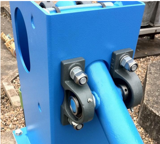
Connectez les roulements à billes de la poignée à l'envers
